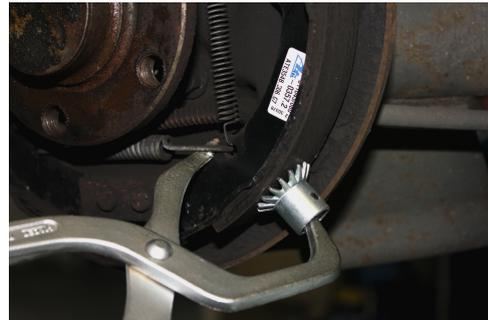
Die ATE-Bremsfederzange (LKW) ist ein unverzichtbares Werkzeug für die sichere und beschädigungsfreie Montage und Demontage von Bremsbacken-Rückzugfedern. Sie verfügt über einen beweglichen, mit scharfen Krallen versehenen Stützteller, der sich auf allen Bremsbelag-Oberflächen abrutschfrei abstützt. Der speziell geformte Haken gestattet das sichere Einhängen der Feder. Damit ist ein bequemer und beschädigungsfreier Ein- bzw. Ausbau der Bremsbackenrückzugfedern gewährleistet.
