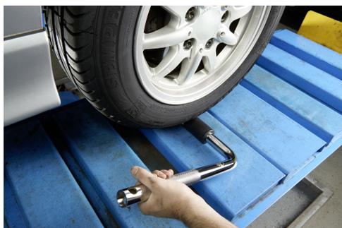
Der Fahrwerksprüfer ist ein einfaches aber sehr effektives Hilfsmittel zur Lokalisierung von Lagerspiel im Bereich von Fahrzeug-Achsen. Unter Belastung des Fahrwerks kann Mithilfe des Fahrwerksprüfers Lagerspiel an Domlager / Silentlager / Traggelenk / Spurstangenkopf / Radlager / Axialgelenk / Lenkgetriebe etc. schnell und einfach lokalisiert werden.
