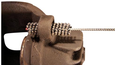
Nach einer gewissen Laufleistung kann es sinnvoll sein, die (Gummi-)Führungshülsen in den ATE Faustsätteln zu erneuern. Die Aufnahmebohrung im Sattelgehäuse ist oftmals mehr oder weniger stark korrodiert. Dadurch wird die Führungshülse eingequetscht und die Führungsbolzen klemmen darin. Der Bremssattel kann sich nicht mehr frei bewegen, in der Folge treten weitere Bremsenprobleme auf.
