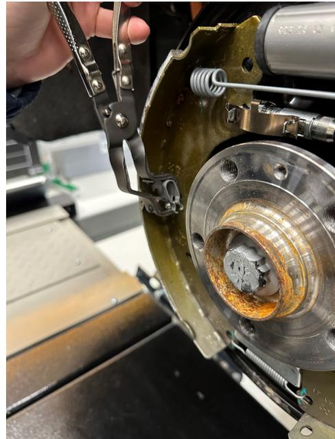
Die ATE-Federn-Montagezange ist ein unentbehrliches Werkzeug für das problemlose Montieren und Demontieren von Trommelbremsbacken-Haltefedern System ATE, das beispielsweise in der Mercedes-Benz A-Klasse, VW ID 3/4/5 zum Einsatz kommt. Ohne die ATE Federn-Montagezange ist der Aus- und Einbau der Haltefeder fast unmöglich.
