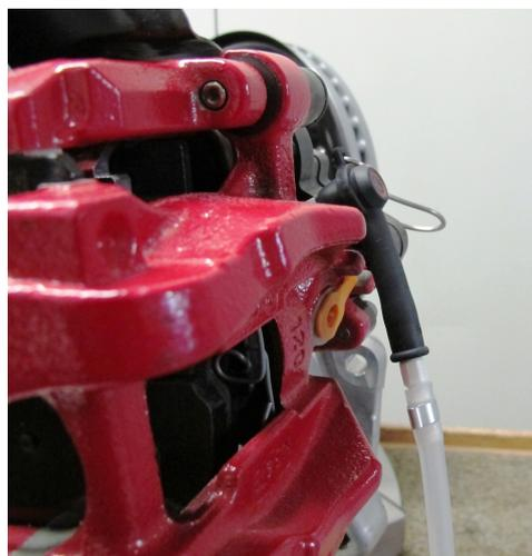
Der ATE 90° Entlüfterschlauch ist ein hilfreiches Zubehör beim Entlüften in engen Bauräumen. Auf Grund seiner kurzen Bauform, baut der Adapter nur 19 mm auf und ermöglicht so die Entnahme von Bremsflüssigkeit an schwer zugänglichen Stellen.
