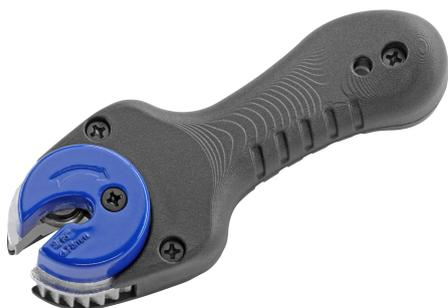
Der ATE Ratschen-Rohrabschneider ist ein ideales Werkzeug für das fachgerechte Abschneiden von Bremsrohren mit einem Durchmesser von 4,75 mm. Dank seiner kompakten Bauweise und der Ratschenfunktion kann er selbst bei beengten Platzverhältnissen auch direkt am Fahrzeug eingesetzt werden. Durch die automatische Nachstellfunktion entfällt das Nachspannen des Schneidrads beim Schneidvorgang. Durch zusätzliche Hebelwirkung aufgrund der Grifflänge ist nur ein geringer Kraftaufwand nötig.
