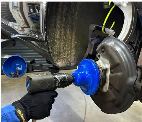
Das ATE Radnaben-Reinigungsset 7 ist ein ideales Werkzeug für ein effizientes, sicheres und preiswertes Reinigen von PKW-Radnaben.
