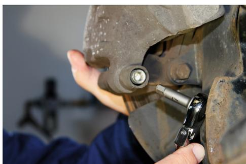
Die oftmals beengten Platzverhältnisse im Bereich der Bremssättel erschweren das Lösen und Festschrauben der Führungsbolzen mit herkömmlichen Werkzeugen.
