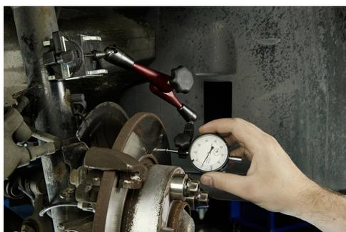
Die ATE Distanzscheiben ermöglichen das schnelle und sichere Befestigen der Bremsscheibe auf der Radnabe. Mittels der original Radschrauben oder Muttern bis M14 mit Kegel- oder Kugelbund wird die Bremsscheibe professionell auf der Nabe befestigt und für das Messen des Plan- und Rundlaufs vorbereitet.
