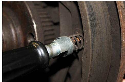
Das ATE Federn-Montagewerkzeug ist ein ideales Hilfsmittel für die problemlose und sichere Montage und Demontage der Halteteller von Bremsbacken-Haltefedern. Es verfügt über zwei unterschiedlich große Aufnahme-trichter und gewährleistet damit das bequeme Arbeiten an Befestigungssystemen sowohl mit großen als auch mit kleinen Federtellern.
